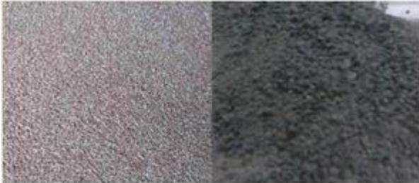
Flux crushed slag
